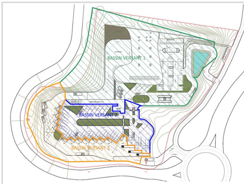
Figure 63 : sous-bassins versants retenus pour l'étude de la gestion des eaux pluviales sur le site.
